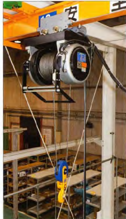
■電動トロリ・ギヤトロリ・ブレントロリ付でホイストとしてもお使いいただけます。
