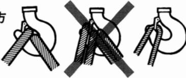
△注意 ③ フックの外れ止め金具が破損したままでは、絶対に使用しないでください。
