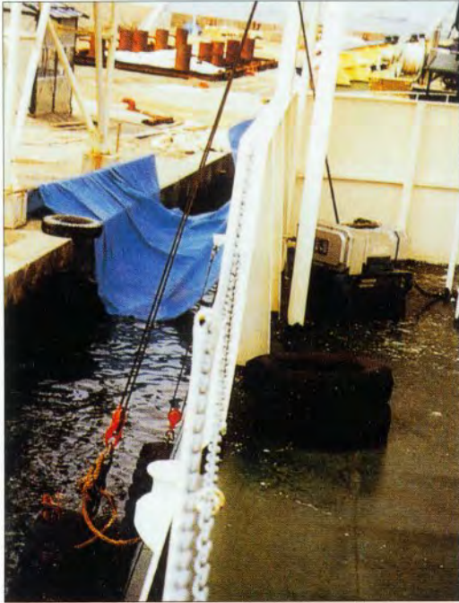
接岸時の緩衝用材を昇降する TX
