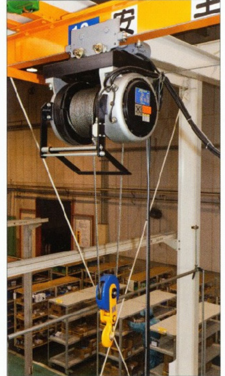
■電動トロリ・ギヤトロリ・プレートトロリ付でホイストとしてもお使いいただけます。
