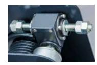
誤操作の逆巻きによる落 下事故防止のため組み 込まれています。更に限 度部のくいつきを少なく する工夫もされていま す。
